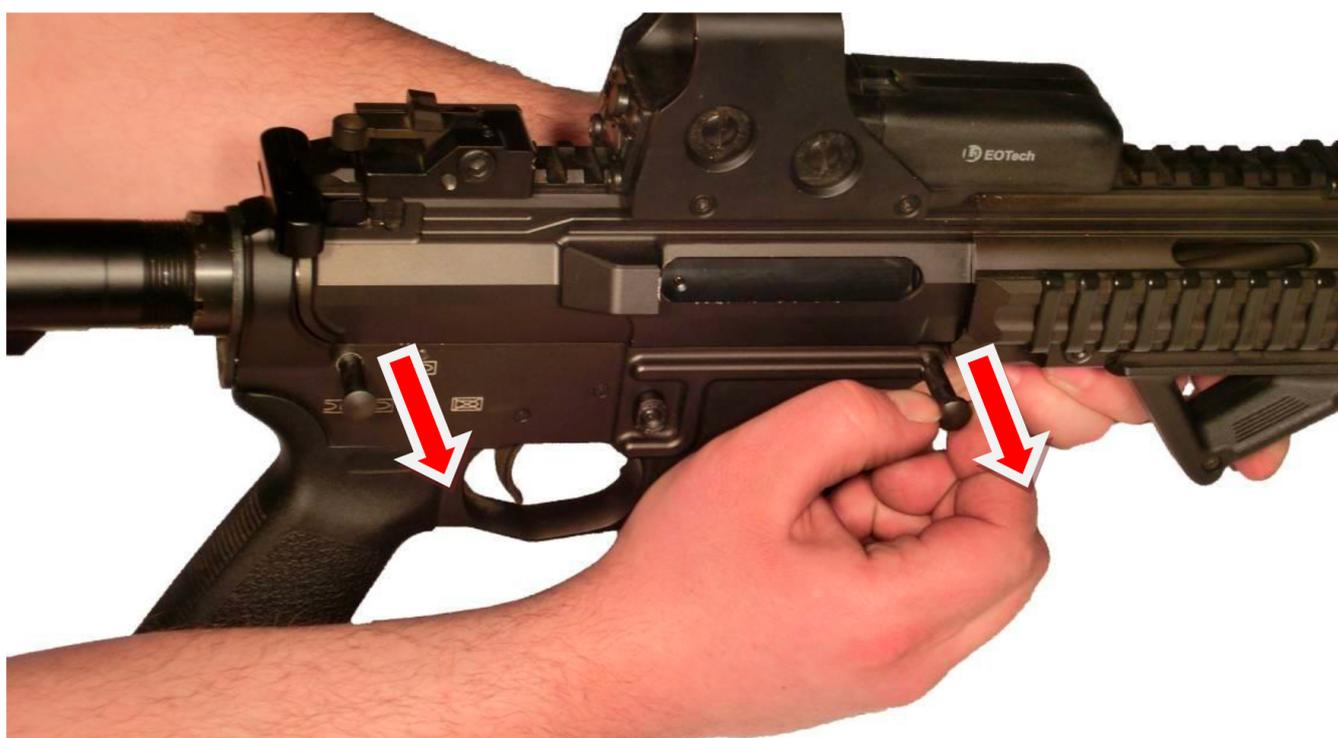
4. Oddělíme horní a spodní rám zbraně. Na spodním rámu zbraně, kterému náleží pažba, pistolová rukojeť, zásobníková šachta a spoušťový mechanismus, již nic více nerozebíráme.
