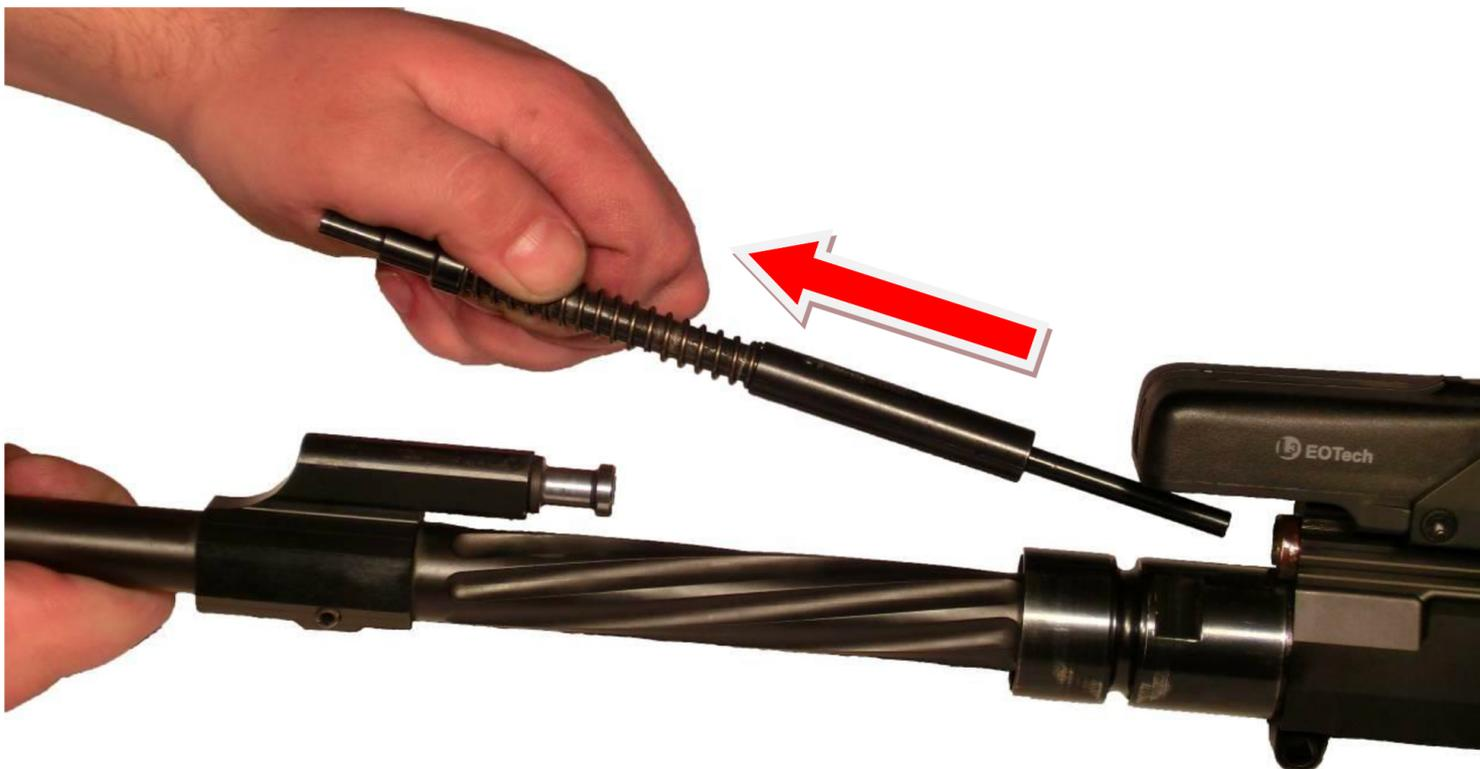
11. Uchopíme píst a pohybem vzad směrem k rámu jej vyjmeme z plynového válce.
