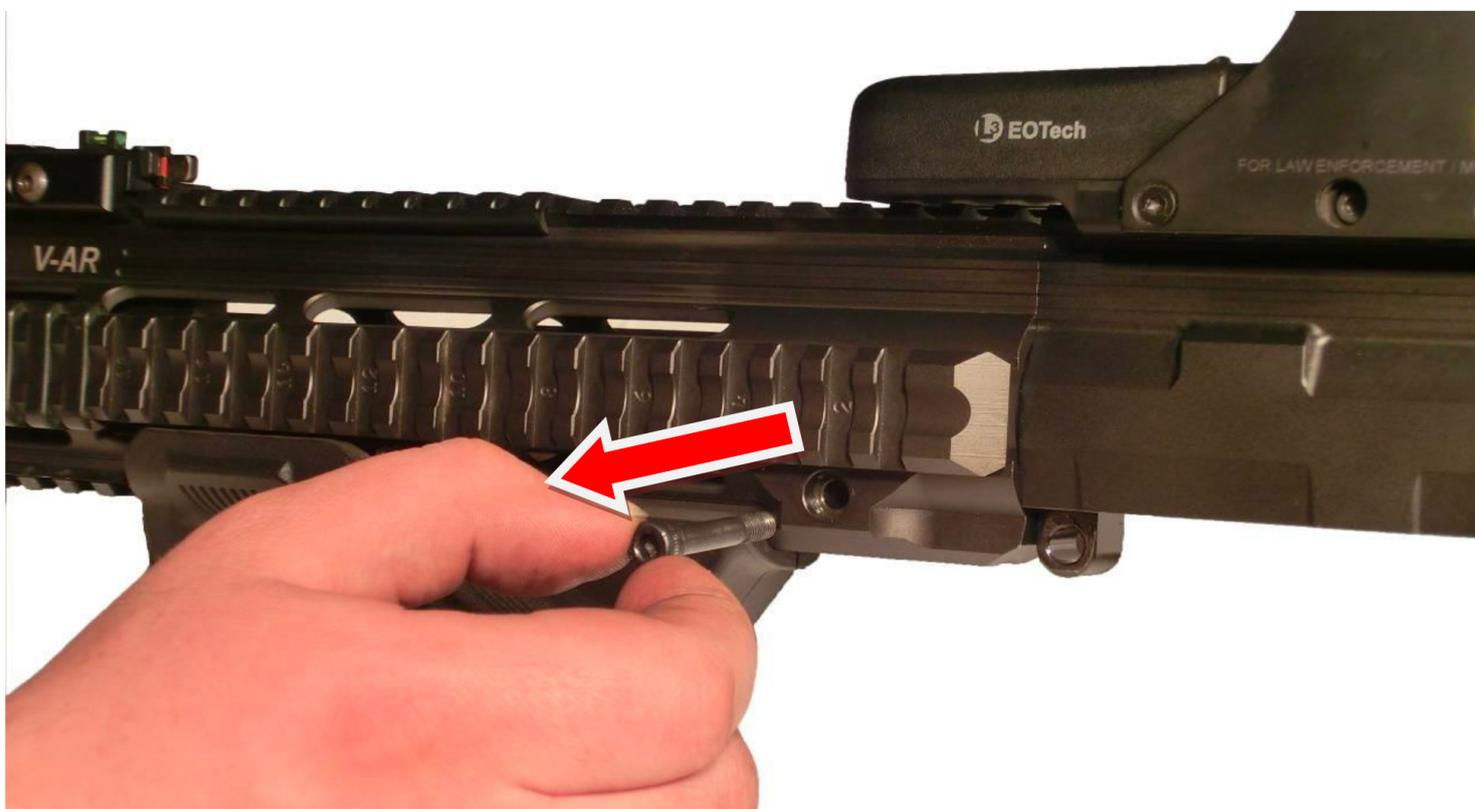
9. Předpažbí stáhneme směrem k ústí hlavně a odejmeme od zbraně. Pokud nelze v první fázi pohybu předpažbí stáhnout z hlavňové matice, můžeme si pomoci lehkým poklepáním na zadní hranu bočních weaver lišt vhodným nástrojem, například gumovou paličkou, kusem dřeva či dřevěnou násadou kladívka.
