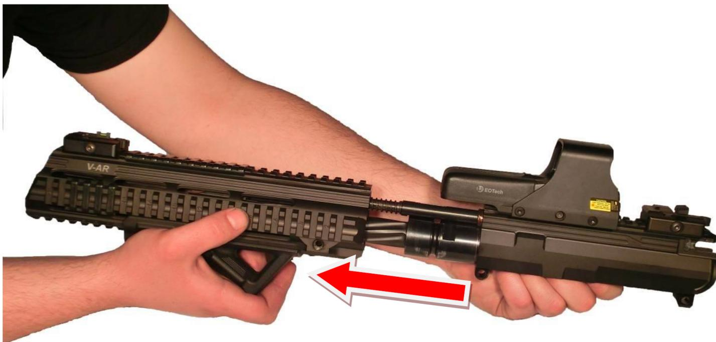
10. Uchopíme pístnici a tlakem proti její pružině ji zatlačíme směrem dozadu do rámu, následně ji vykloníme předním koncem vzhůru směrem od hlavně a tahem vyjmeme ven směrem kupředu k ústí hlavně. Je nutné, aby natahovací páka závěru byla vyjmuta z rámu nebo stažena do zadní pozice, jinak nelze pístnici vyklonit vzhůru!
